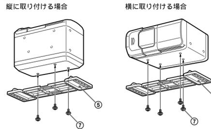
**2** 取り付け面の汚れをふき取り、本機と取り付け台B⑥を合わせ、固定位置を決めてから⑥を貼り付ける。
