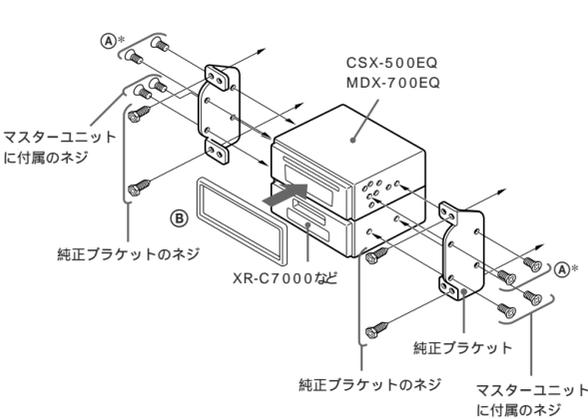
\* 付属の皿ネジ④で取り付けてください。他のネジを使用しないでください。故障の原因となります。
